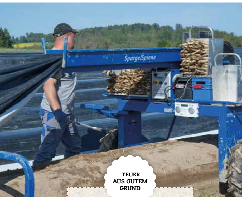
Die Spargelspinne hebt das Flies an und macht den Damm frei, um den weissen Spargel zu stechen.
