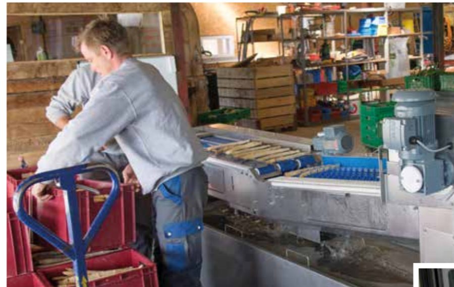
Dank der automatischen Sortier- und Waschanlage landen die gebündelten Spargeln sehr schnell im Kühler.
